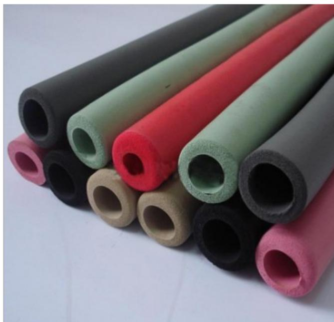
橡塑保温材料的主要原材料是橡胶和塑料，其单体寿命塑料比橡塑要长得多，橡胶主要是其老化效应。使用寿命应该理解为正常使用寿命，即是制品不处于高温、高湿、有腐蚀性介质及强氧化、强冲击等恶劣环境下的使用寿命。所以根据橡胶塑料制品的正常使用状态，橡塑材料可正常使用15年以上。所以，在橡塑保温板的日常维护中，应当防止被尖锐物品刮破，管道表面定期用干抹布擦拭，管道检修时，局部拆卸应注意方法；橡塑保温材料可针对不同的橡塑复合面层用干抹布擦拭，橡塑复合绝热材料是通过多项复合技术将面材与橡塑绝热材料进行复合，在正常环境条件使用下复合层不会脱落。橡塑保温杜肯板具有较度及较好弹性，具有一定耐压力、经过打褶处理的保温橡塑板具有较大的拉拔强度，不易起层，提高了牢固耐久性。保温橡塑板还有很好的保温、阻燃效果，所以被用到风管空调建筑保温系统中非常受欢迎。湖北供应橡塑供应商泰州
